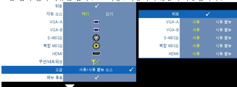
**VGA-A**—**[←]** 및 **[→]**을 사용하여 VGA-A 입력 사용 / 비활성화를 조정합니다.
